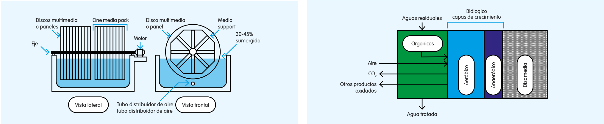
Figura 2. Diagrama esquemático de un RBC típico (izquierda) y una sección transversal esquemática de la cara de contacto del medio del lecho en un RBC (derecha), 3 adaptado por SNV
