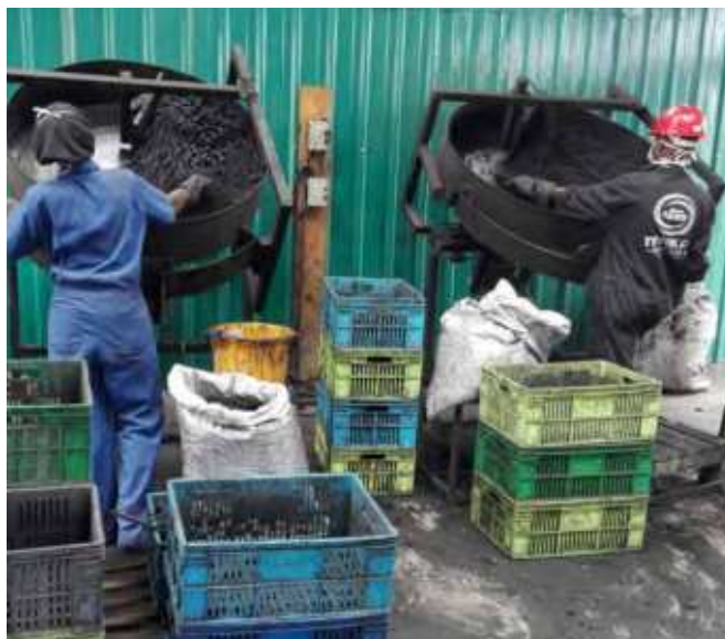
Aglomerador en funcionamiento con tambor giratorio
