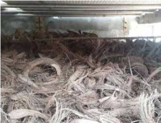
Filtrado de efluentes en lecho filtrante de polvo de coco
