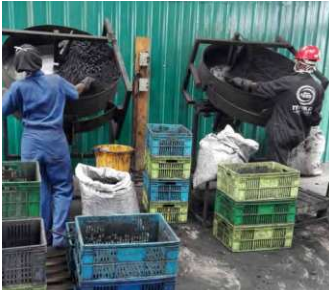
Aglomerador em funcionamento com tambor rotativo
