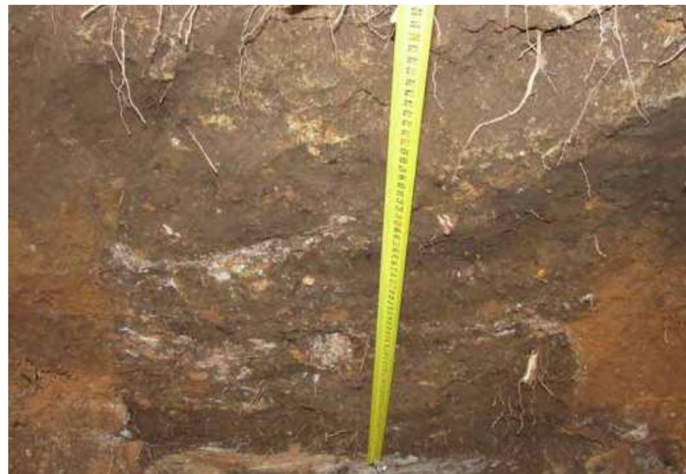
Lodo decomposto após 3,5 anos no sítio Umlazi (África do Sul)
